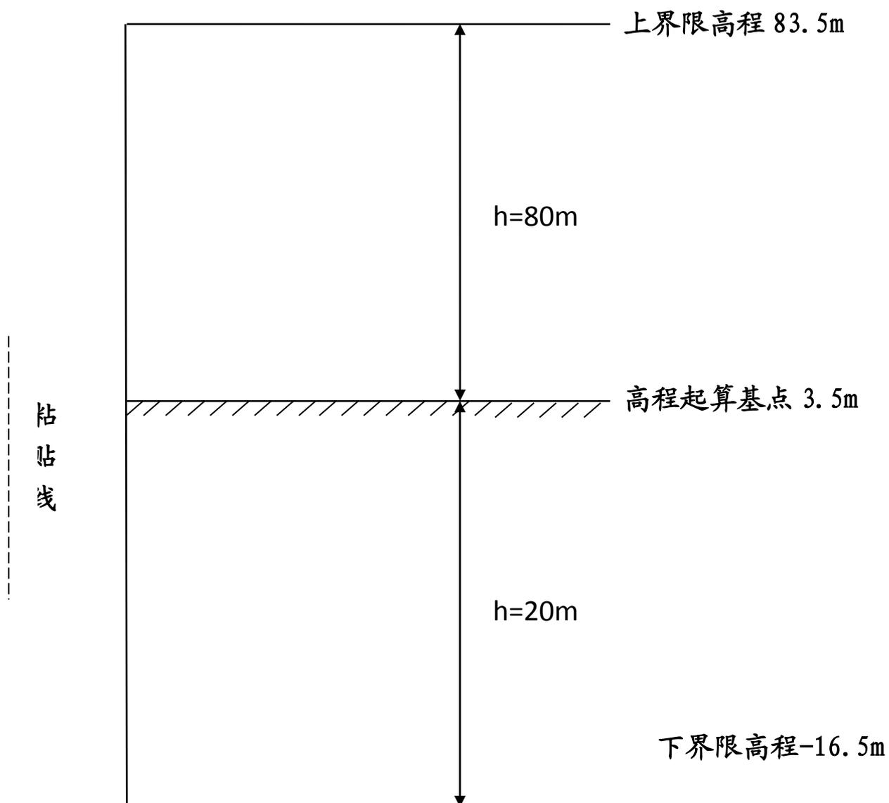
高程起算基点 3.5 米，上界限高程 83.5 米，下界限高程 -16.5 米。以规划要求中场地地面标高上限为高程起算基点，以规划要求中建筑檐口限高作为上界限高程，以规划要求中地下建筑地坪限低作为下界限高程。采用的高程系和规划要求一致。对于建筑物实际高度超过建筑檐口限高的部分，如取得规划批准，则不作为违章处理。
